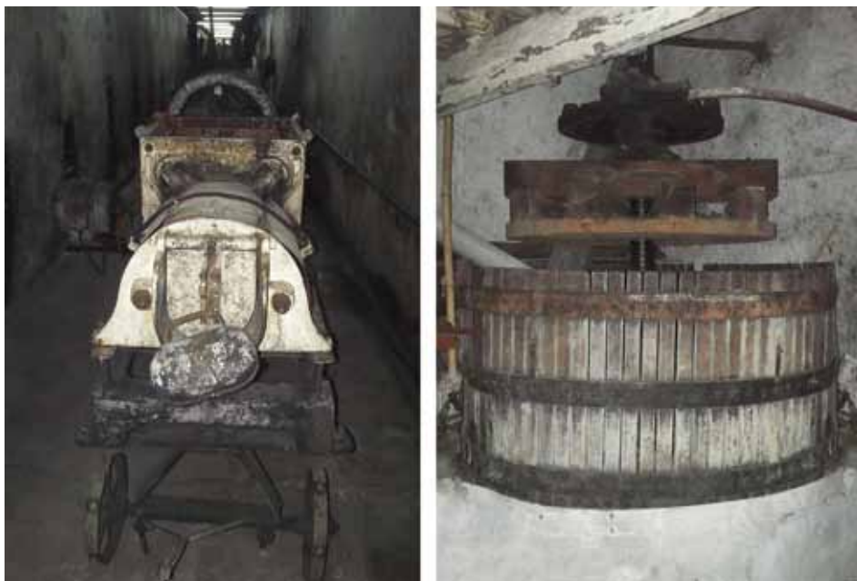
Figura 5. Izquierda: Filtro transportable que trabaja en base a tierra; Derecha: prensa manual de 3 m de diámetro y 1.20 m de altura (fines del siglo XIX)
