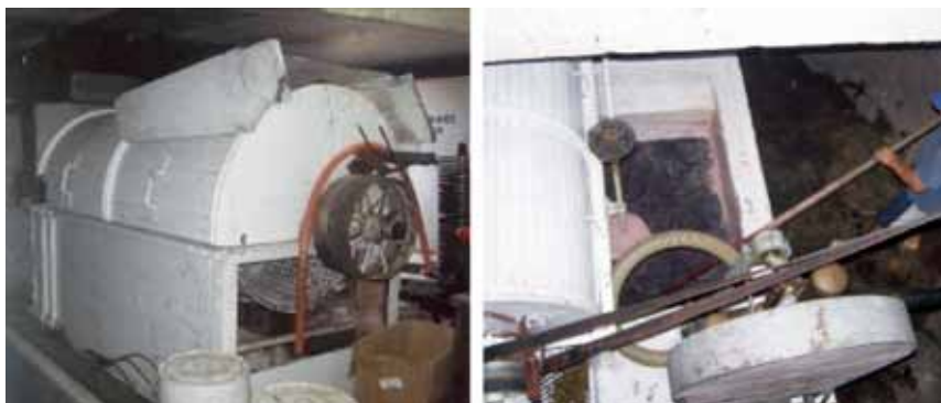
Figura 4. Moledora de uva a vapor, actualmente adaptada con motor eléctrico (fines del siglo XIX)
